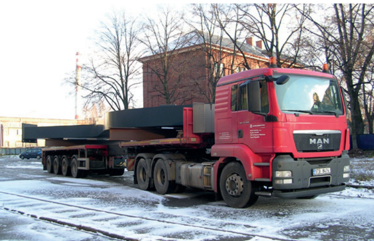
Celá trasa přepravy dílců byla plánována s ohledem na provoz, podjezdy, nadjezdy, tramvajové vedení...
