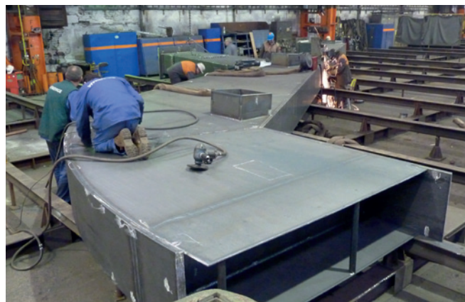
Výroba probíhala podle normy ČSN EN 1090-2+A1, tř. provedení EXC3.
