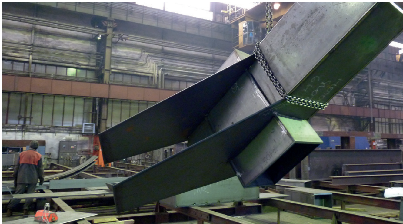
Dělení na rozměrnější dílce bylo umožněno výrobními možnostmi hal.
