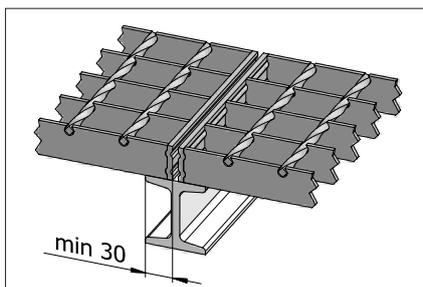
Minimální projektovaná šířka uložení roštu na nosné konstrukci je 30 mm, tak aby ve smontovaném stavu nebylo uložení menší než 25 mm. Doporučuje se však, aby šířka uložení roštu byla rovna výšce roštu.
