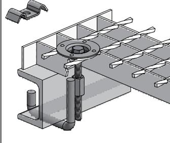
**Hákový upevňovací prvek B 833T evt. B 833K**
