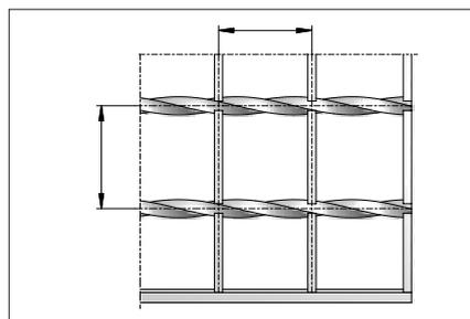
Osová vzdálenost mezi nosnými pásy a mezi rozpěrnými pruty.
