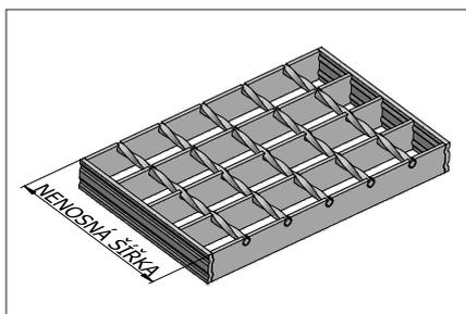
Vnější rozměr roštu ve směru rozpěrných prutů. Tento rozměr je nazýván šířkou i tehdy, je-li větší než délka
