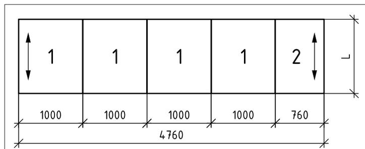
Použití standardních šířek a zbytkového pole tvořeného výrobní šířkou
