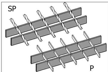
Ploché tyče mezi dvěma podpěrami roštu. Nesou zátěž, jsou k sobě navzájem uspořádány rovnoběžně.
