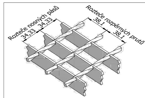
Osově rozteče nosných pásů a rozpěrných prutů u standardního rozměru oka.
