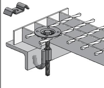
**Hákový upevňovací prvek B 733T evt. B 733K**
