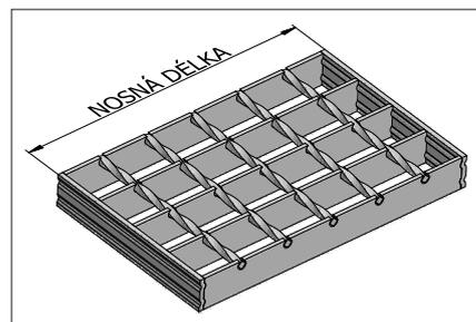
Vnější rozměr roštu ve směru nosných pásů. Tento rozměr je nazýván délkou i tehdy, je-li menší než šířka.
