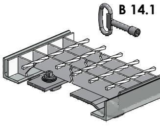
**Upevňovací prvek zámkový B 13.1 čtyřhran 7 mm nebo B 13.2 čtyřhran 8 mm**
