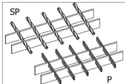
Příčné tyče k nosným pásům, v místě křížení s těmito pásy svařeny nebo do nich zalisovány.
