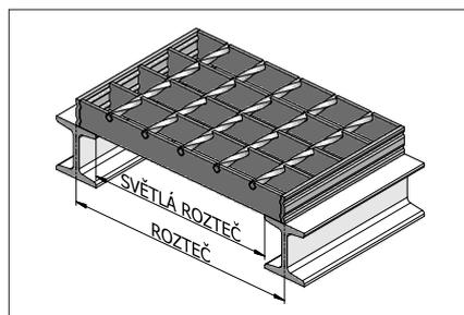
Rozměr od středu (osu) podpory po střed (osu) podpory. Světlá rozteč podpor je světlá vzdálenost mezi podporami.
