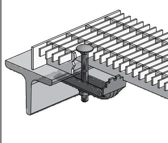
**Upevňovací prvek B 10 pro rošty s roztečí rozpěrných prutů 11,11 mm**
